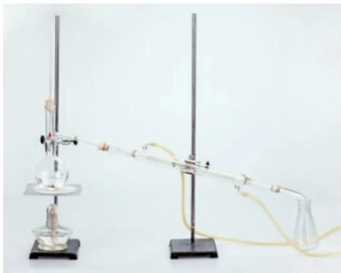
图4-13 实验室常用的蒸馏装置
