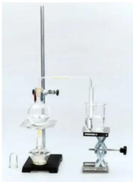
图4-14 制取蒸馏水的简易装置
